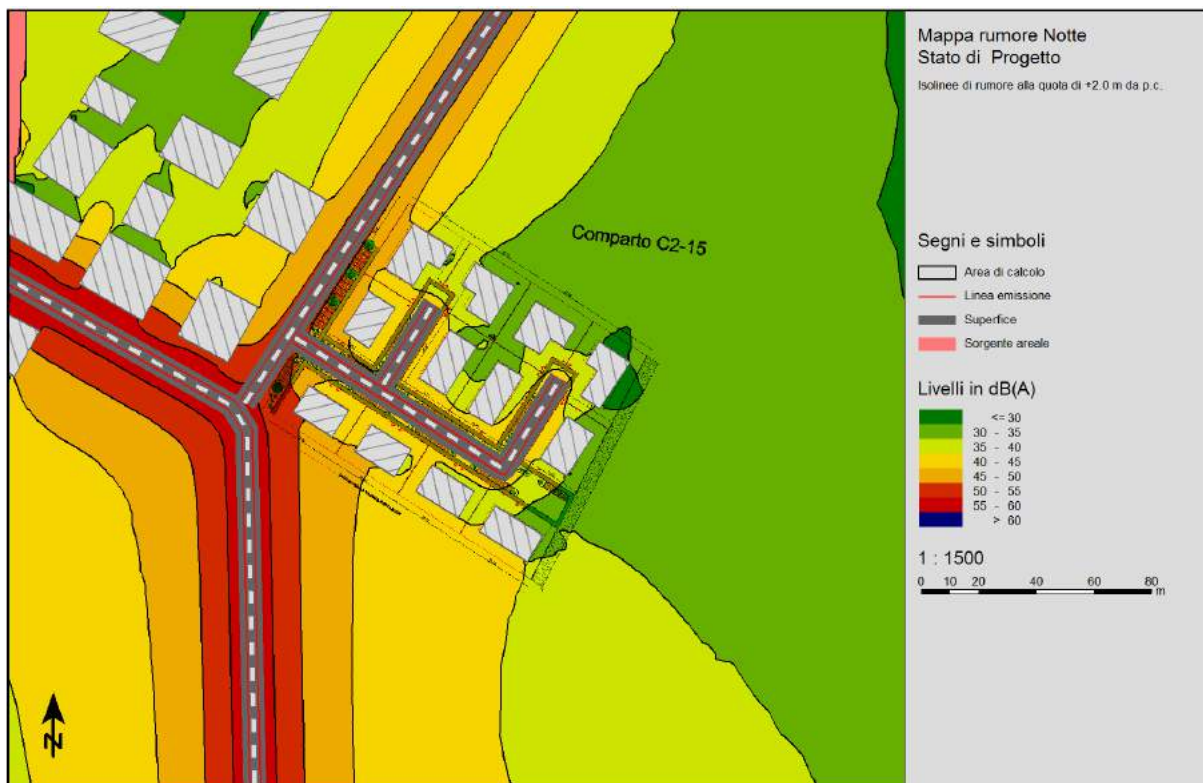
Fig. 11.3 - Mappa del rumore stato di progetto riferita al periodo notturno. Livelli ad altezza di +2 m da terra.
