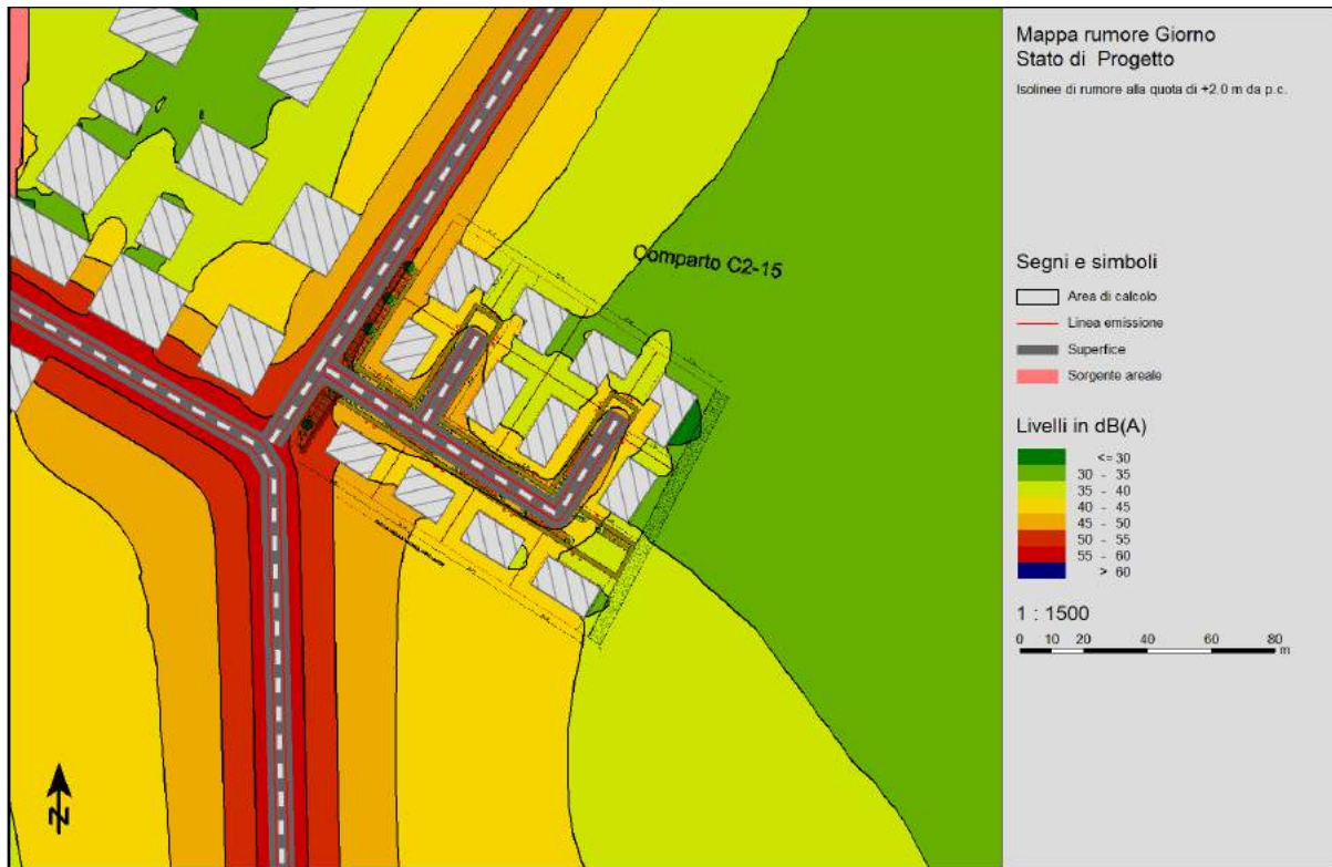
Fig. 11.2 - Mappa del rumore stato di progetto riferita al periodo diurno. Livelli ad altezza di +2 m da terra.
