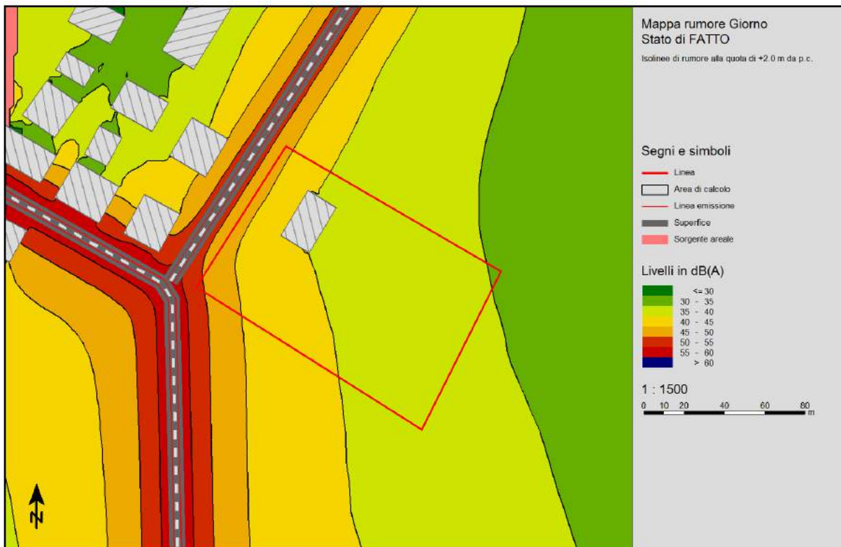
Fig. 10.3 – Estratto della mappa del rumore stato di fatto riferita al periodo diurno. Livelli ad altezza di +2 m da terra.
