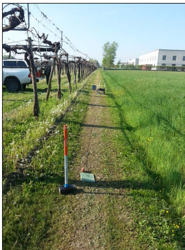
Ripresa fotografica dello stendimento sismico MASW eseguito nell'area di indagine.
