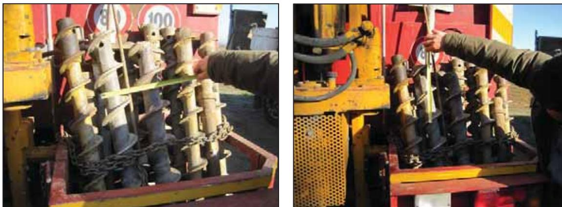
Fig. 2.2: Ripresa fotografica di dettaglio dell'elica utilizzata per il prelievo dei campioni.
