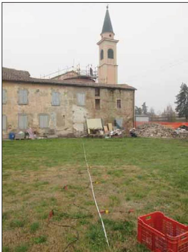
Fig. 4.4: Ripresa fotografica di parte dello stendimento Masw.
