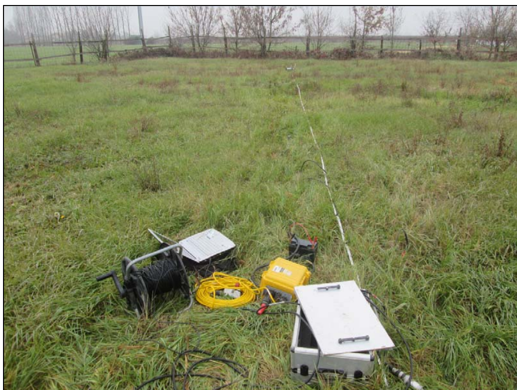
Fig. 4.2: Ripresa fotografica di parte dello stendimento Re.Mi eseguito.
