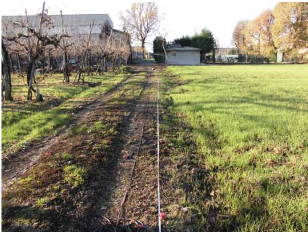
Foto 4.2.1.1 e 4.2.1.2- esecuzione linee sismiche e attrezzatura di registrazione
