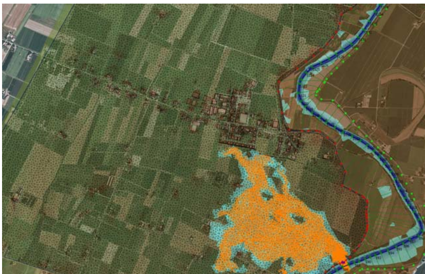
Simulazione dell'esondazione : dopo circa 1 h 30' l'onda di piena raggiunge l'abitato di Sozzigalli.
