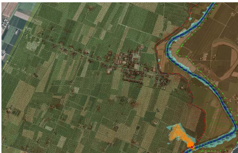
Simulazione dell'esonazione : crollo dell'argine
