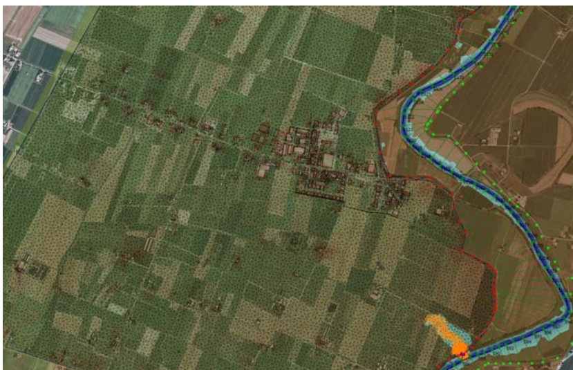
Simulazione dell'esonazione : sifonamento dell'argine
