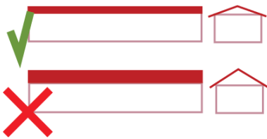
Fig. 3.3.2 Falde larghe a bassa inclinazione in quanto meno visibili dalle grandi distanze, negli edifici non abitativi di grandi dimensioni
