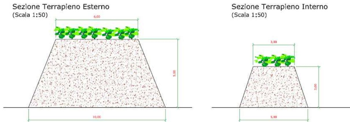
Figura 6 - Sezione terrapieno esterno ed interno
